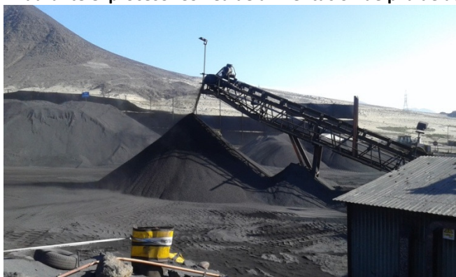
Ilustración 9-19: Planta de reciclado de pellets aglomerados durante el proceso. Correa de alimentación de pila de acopio
