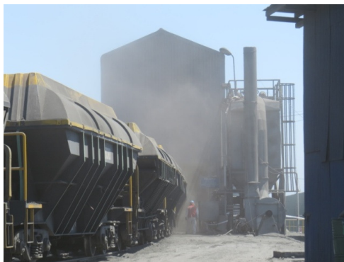
Ilustración 9-1: Descarga de pre-concentrado en CAP
