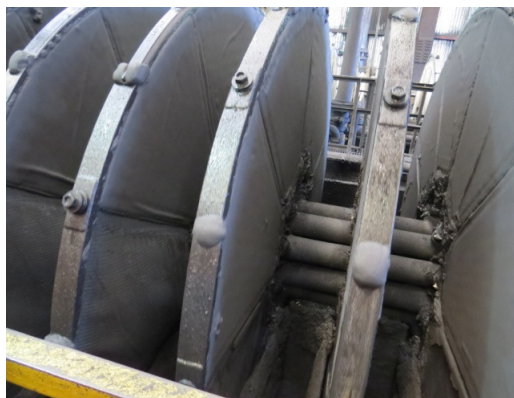
Ilustración 9-3: Filtrado de concentrado
